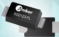
SOD123-FLパッケージは通信機器の小型化を可能にする、コンパクトな表面実装パッケージです。Cuクリップ構造により、ワイヤボンディング製品と比較して電気抵抗が低減され、また熱性能が強化されます。
