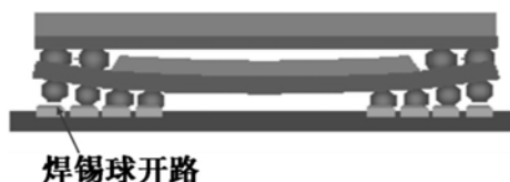
图 3 翘曲导致封装焊接失败
