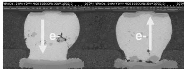
图 9 High Pb 凸点的失效位于基板一侧(负极侧)
