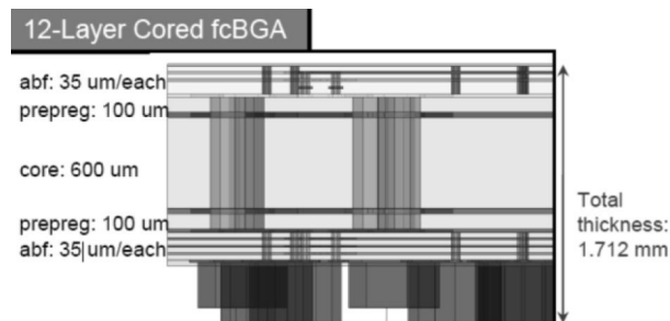
图1(a) 12层双核层叠积层式基板,封装厚度为1.712mm
